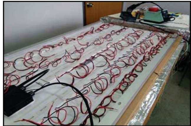
RAJAH 1. Gambar rajah peranti TE dilampirkan di belakang modul PV
