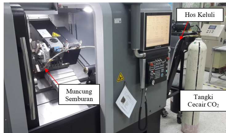
RAJAH 1. Susun atur mesin larik dan peralatan saluran kriogenik
