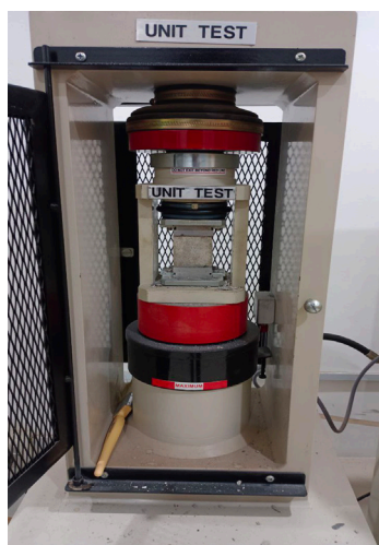
RAJAH 6. Ujian mampatan sampel Mortar
