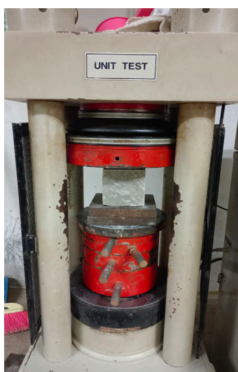
RAJAH 7. Ujian mampatan sampel konkrit
