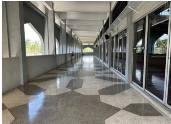
RAJAH 14. Ruang limpah ( koridor) membantu menghalang kemasukkan haba matahari.
