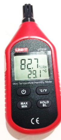
RAJAH 1. Alat mengukur suhu dan kelembapan iaitu UNI-T Mini Temperature Humidity Meter (UT333).
