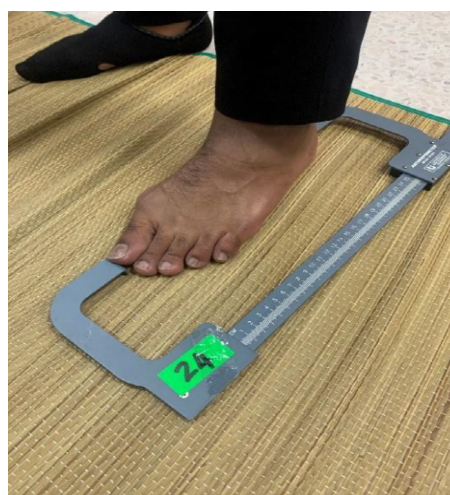
RAJAH 2. Pengukuran antropometrik kaki subjek menggunakan (a) alat antropometer dan (b) angkup vernier
