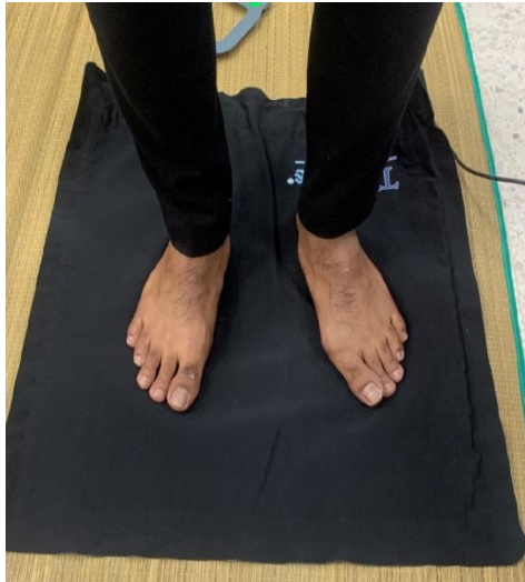
RAJAH 3. Proses pencerapan data taburan tekanan pada tapak kaki subjek menggunakan Tactilus Mat
