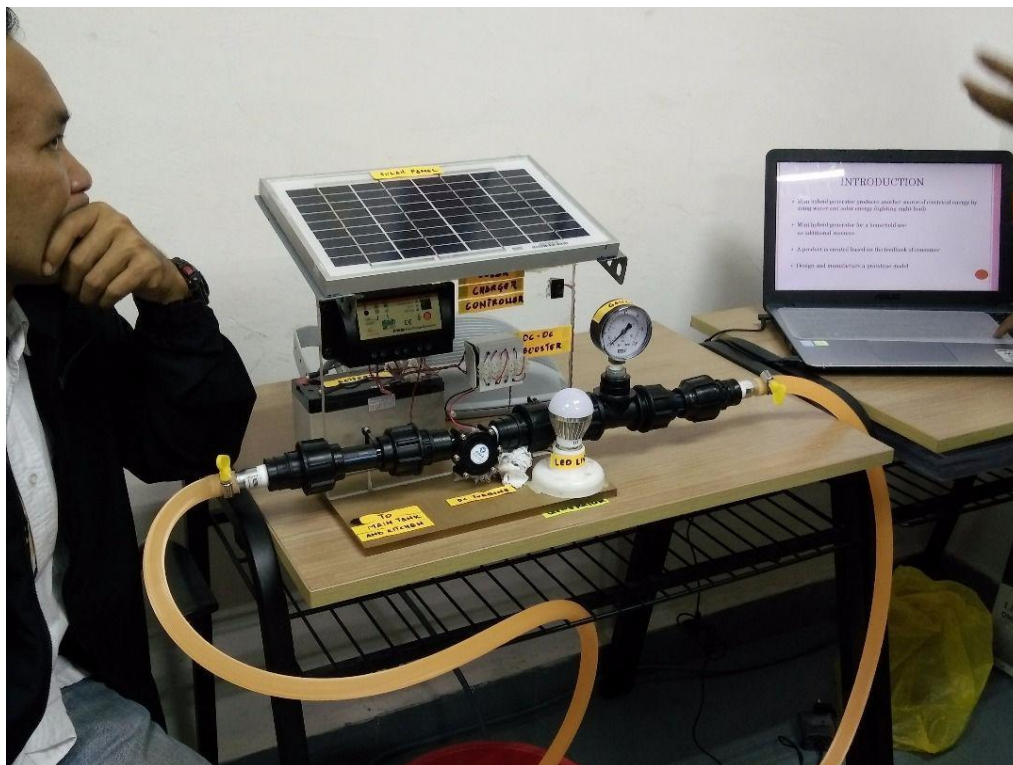
Rajah 3: Prototaip penghasilan tenaga elektrik melalui pergerakan air di saluran paip serta digabungkan bersama tenaga elektrik solar
